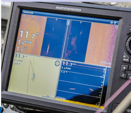
Hochwertige Geräte verfügen zudem über neue Technologien, mit denen Signale seitlich vom Boot erfasst werden.
